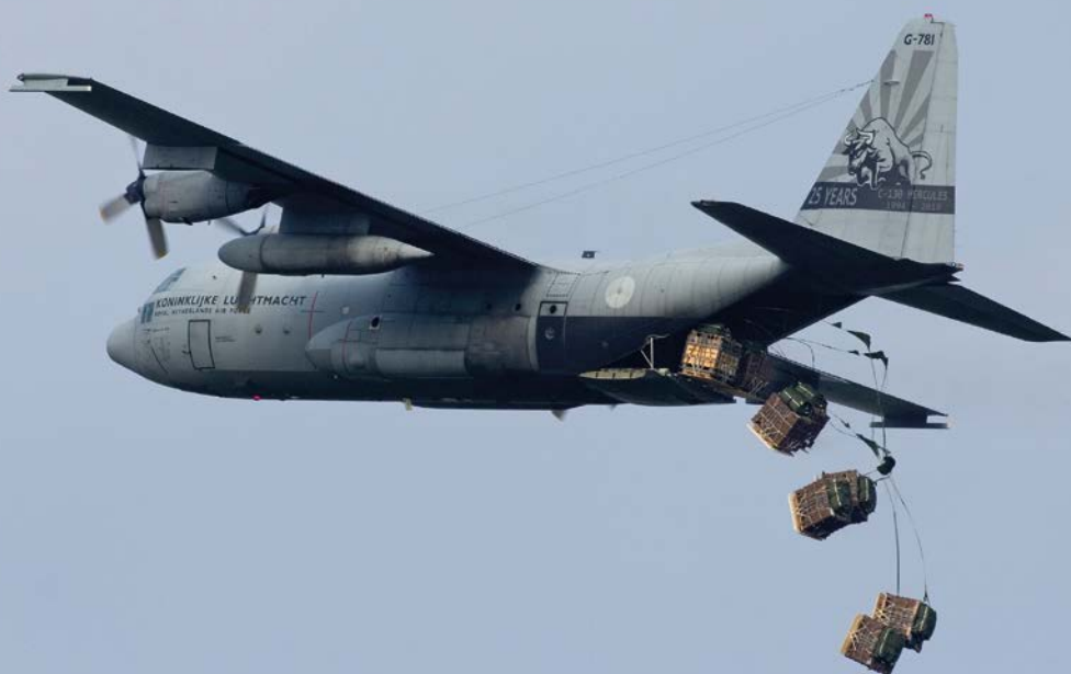
Een C-130H van 336 Squadron dropt acht pallets met behulp van het container delivery system, tijdens een avondmissie boven de Marnewaard op 7 september.
