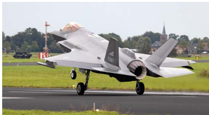
Het enige verschil tussen Noorse en Nederlandse F-35's is de remparachute, waarvan de behuizing goed te zien tussen de twee staartdelen. Op 6 oktober landen twee Nederlandse vliegers in Noorse F-35's met gebruik van de remparachute. Foto: Frank Crebas
