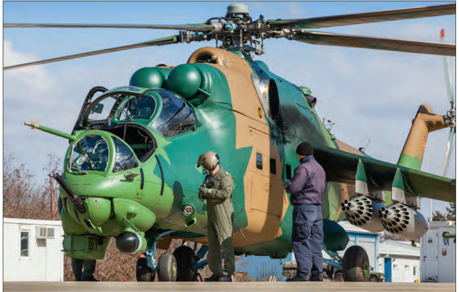
Een piloot van de Noord-Macedonische Air Brigade voert zijn pre-flight inspecties uit bij zijn Mi-24V op de flightline van de vliegbasis Petrovec. Goed te zien zijn de UB-32-57 Rocketpods, die elk 32 ongeleide 57 millimeter S5 raketten kunnen afvuren, alsmede het vierloops 12,7 millimeter Yak-B kanon in de neus.
