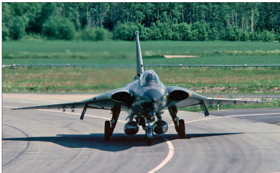
De Filip was voorzien van een IRST (Infra-Red Search and Track) sensor onder de neus, aangeduid met S71N. Het was een in licentie gebouwde versie van de Hughes AN/AAR-4.
