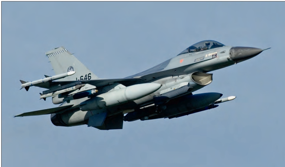
Nogmaals de J-646, nu met onder de rechtersvleugel een GPS-geleide GBU-38 JDAM van 500 pond en onder de linkersvleugel (nauwelijks zichtbaar op de foto) een laser- en GPS-geleide (dual mode) GBU-49 Enhanced Paveway II van eveneens 500 pond.
