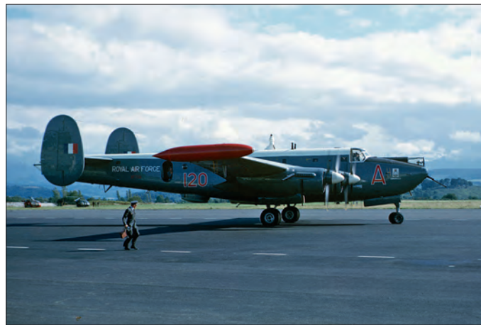
Een Shackleton MR.3 van 120 Squadron met boven op de romp de ARI 18144 Orange Harvest ECM 'spark plug'. [Archief WFH]
