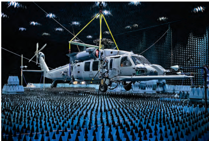
Onderdeel van het ontwikkelingstesten en evaluatie van de nieuwe HH-60W Combat Search and Rescue helikopters van de USAF is een verblijf in de echovrije kamer van de Joint Preflight Integration of Munitions and Electronic Systems faciliteit op de vliegbasis Eglin (Florida). De foto laat een van de HH-60W's zien van het 413th Flight Test Squadron aan het plafond van die echovrije kamer. Doel is het testen van de defensieve systemen van de Whiskey. [USAF, Sam I King]
