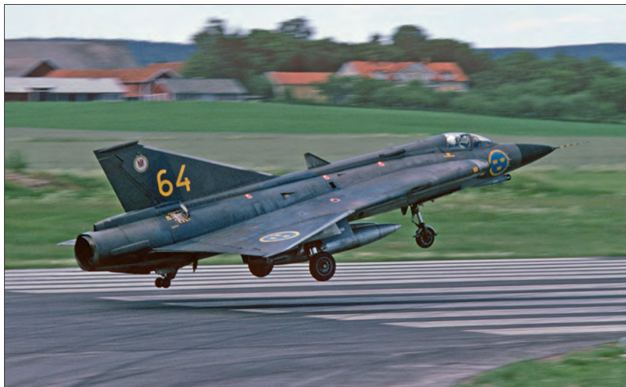
Bij de landing was het de bedoeling een 'driepunter' te maken op de hoofdwielen en het intrekbare dubbele staartwiel en daardoor maximaal te profiteren van 'aerodynamic braking'.
