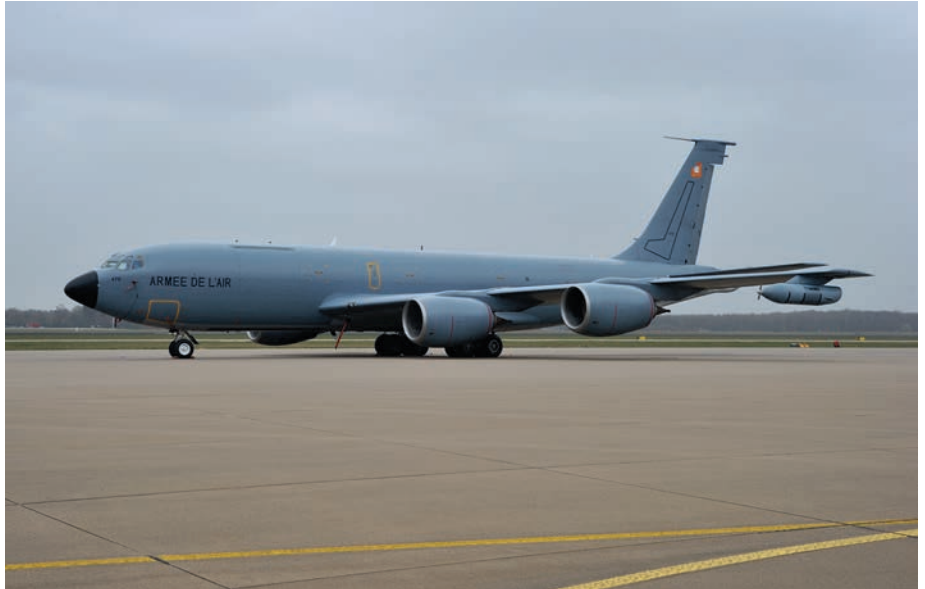
De Franse deelnemer, een Boeing C-135FR. Deze tanker kan zowel 'drogue'-receivers, zoals de Eurofighter en de Tornado, van brandstof voorzien als 'boom'-receivers zoals de F-15 en de F-16. Dat geeft de planners van tankermisies veel flexibiliteit.
