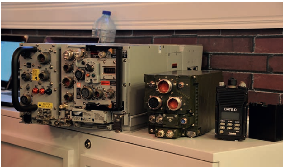
De ontwikkeling van de Link 16 terminals naar een steeds kleiner formaat. Links de flink uit de kluiten gewassen terminal van de F-16, in het midden een low volume apparaat t.b.v. helikopters e.d. en rechts de nieuwe handheld BATS-D AN/PRC-161 van fabrikant ViaSat.
