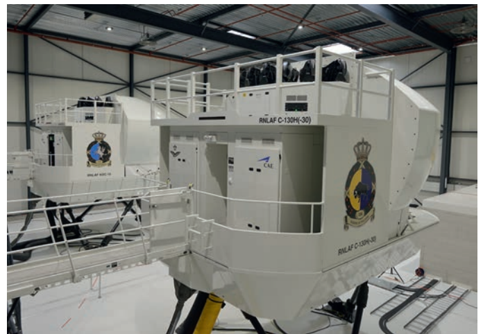
De twee Full Flight simulatoren (level D), links die voor de KDC-10, rechts die voor de C-130H(-30), in het nieuwe simulatiecentrum Gate2 in Rijen.
