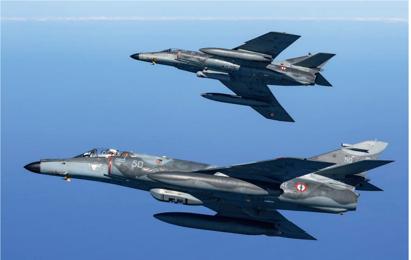
Twee SEM's met verschillende configuraties. De achterste heeft een Damocles doelaanwijspod onder de romp, de voorste een CRM280 verkenningssysteem.
