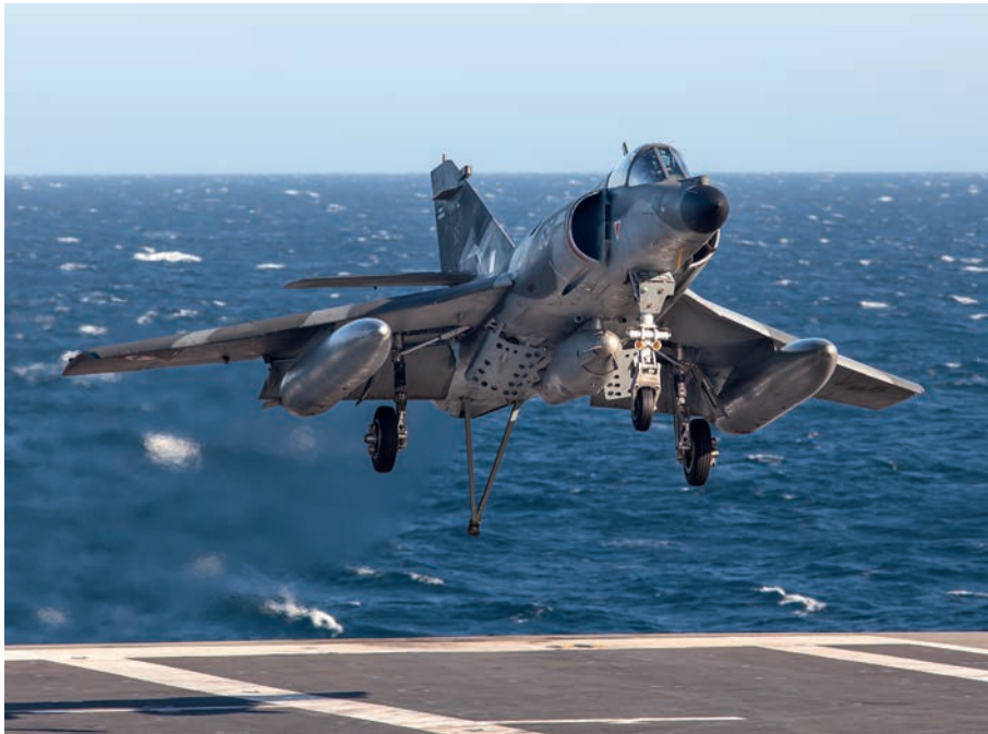
DSEM in tanker configuratie, ook wel NouNou (nanny) genoemd. Let op de karakteristieke V-vormige vanghaak en de dikke bijtankpod onder de centerline.
