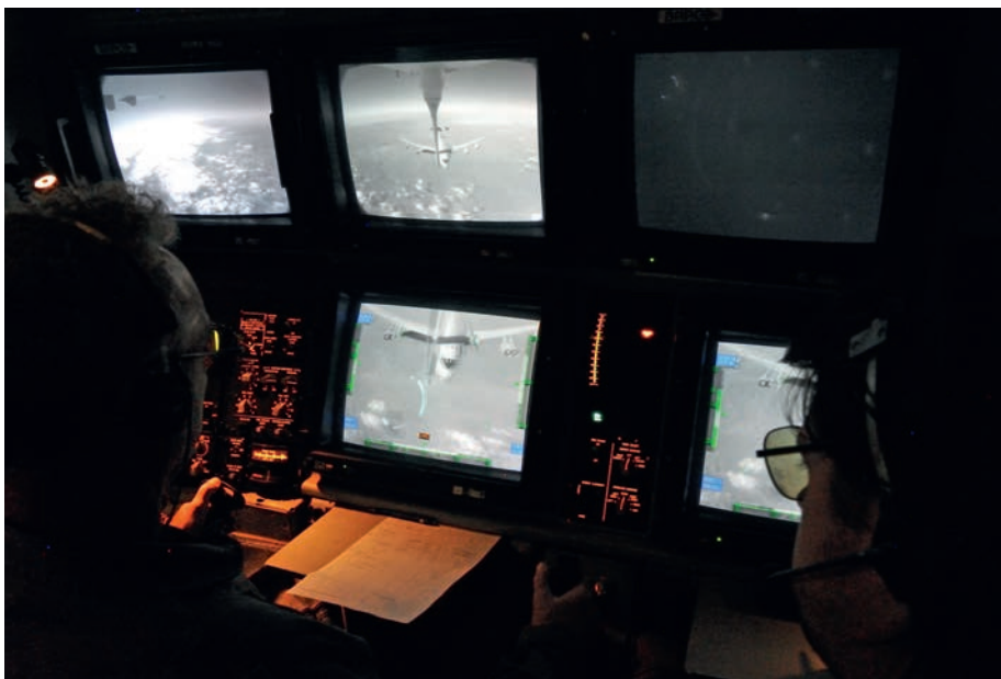
Na 2,5 uur vliegen nadert boven Roemenië een E-3A van de NAEW&CF. Sergeant-majoor Carl, nu in de rol van boomoperator, bedient met zijn twee joysticks de tankbuis en communiceert met de vliegers. Rechts collega Mark.
