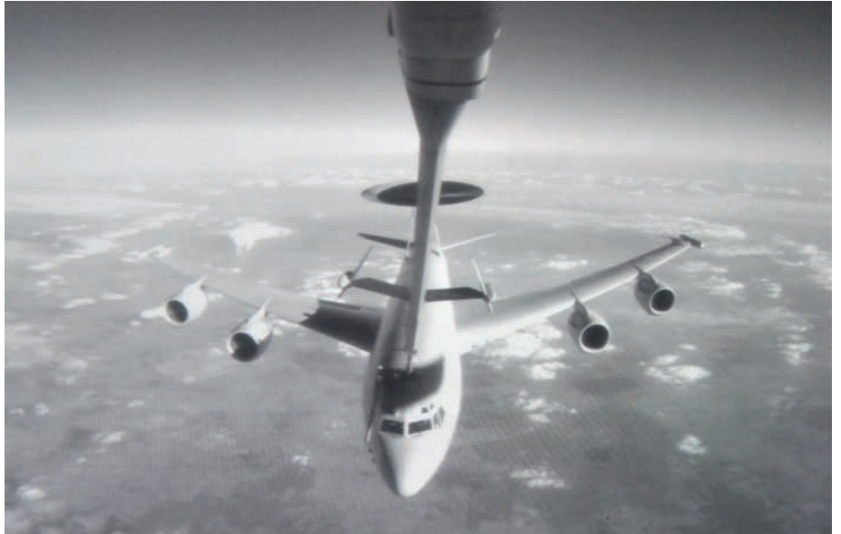
De probe op de neus van de E-3D is duidelijk te zien. Als er een schaduw over de tankopening valt heeft de boomoperator moeite de tankopening goed te zien en dan moet de poging soms worden afgebroken. Een kleine wijziging van koers, waardoor de schaduw anders, valt kan dan helpen.
