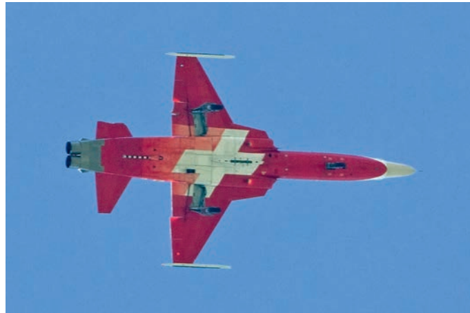
Zoals op deze foto te zien verloor F-5E J-3088 bij de botsing met de J-3086 een groot deel van het stabilo aan de rechterzijde en raakte de rechter flap beschadigd. Desondanks wist kapitein Rodolfo Freiburghaus het toestel veilig aan de grond te zetten. [Kees van der Mark]
