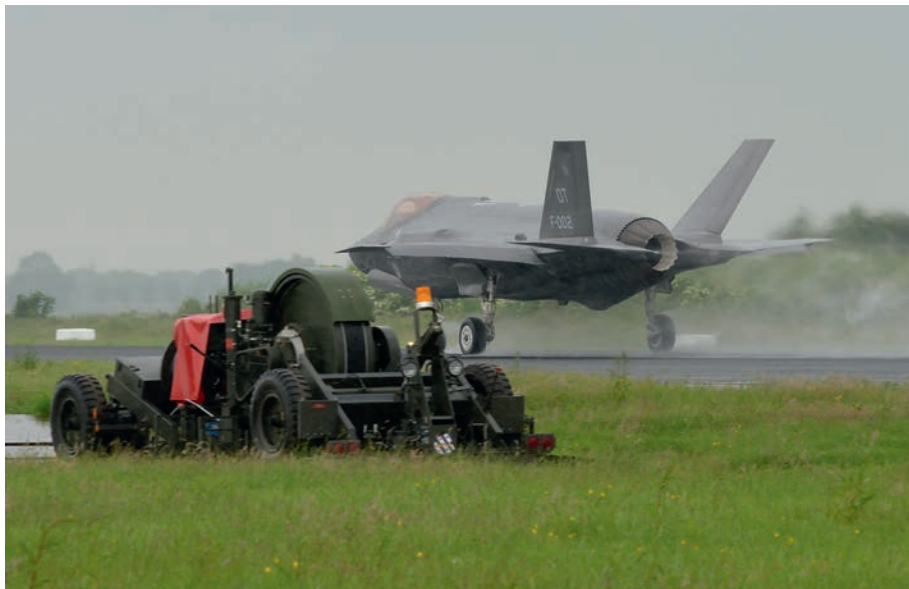
Speciaal voor de F-35's werden op Leeuwarden en Volkel mobiele remkabelinstallaties geplaatst die een hoger gewicht aankunnen en zijn aangeschaft voor inzet in uitzendgebieden.
