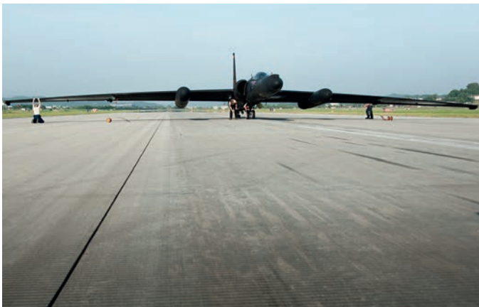
Op 2 juni wordt U-2S 68-0329 na terugkomst op Osan van een sortie gestabiliseerd door onderhoudspersoneel voor het aanbrengen van de zogenaamde pogo sticks om terug te kunnen taxiën naar de hangar. Het toestel, van het 5th Reconnaissance Squadron 'Blackcats', vloog tijdens die sortie als eerste U-2S zijn 30.000ste vlieguur. [USAF, SSgt Jonathan Steffen]
