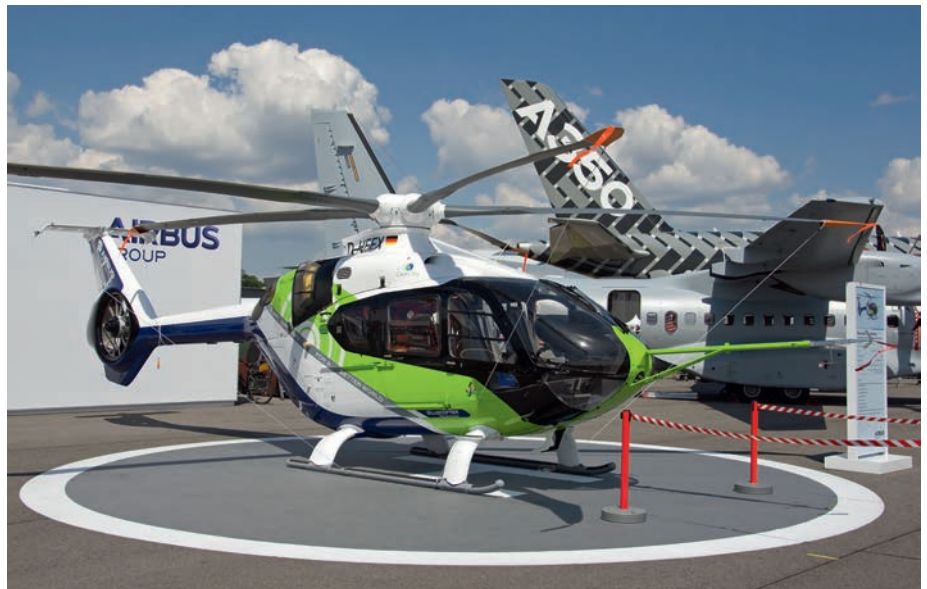
Airbus Helicopters toonde in Berlijn de Bluecopter Demonstrator, een op de H135 gebaseerde heli die veel efficiënter en milieuvriendelijker is dan de huidige generatie helikopters.
