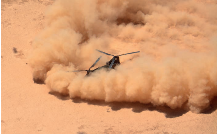
Een brown-out landing in Mali waarbij het zicht vanuit de cockpit tot bijna nul gereduceerd wordt.
