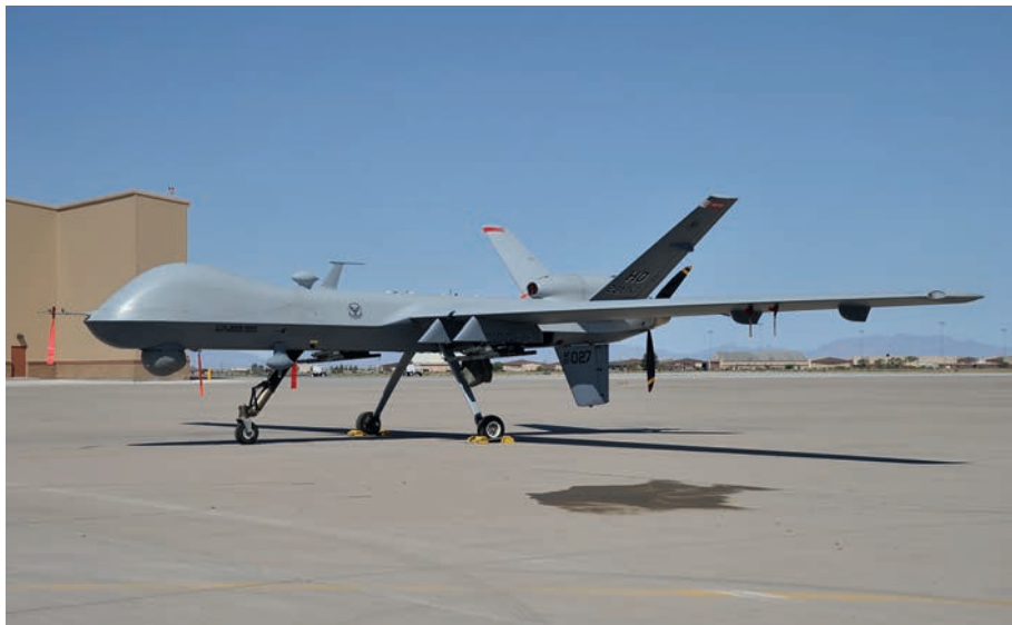
In de 'kin', net voor de bol, bevindt zich de Lynx AN/APY-8 Synthetic Aperture Radar (SAR). Deze MQ-9B Block 1 Reaper behoort tot het 29th ATKS (Attack Squadron), MQ-9 Formal Training Unit, 49th Wing op Holloman AFB in New Mexico.
