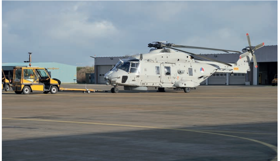
De NH90's staan op Maritiem Vliegkamp De Kooy in de hangar 'met de oortjes in de nek', d.w.z. met de rotorbladen naar achteren gevouwen. Ze worden op het platform uitgevouwen.
