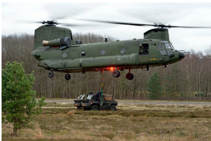
Een Chinook heeft tijdens de oefening 'Falcon Frostfire' twee speciale Luchtmobiele voertuigen als 'slingload' vervoerd en afgezet op Zutendaal, een in 1953 gebouwde reservevliegbasis in Oost-België. [Foto's: WFH]
