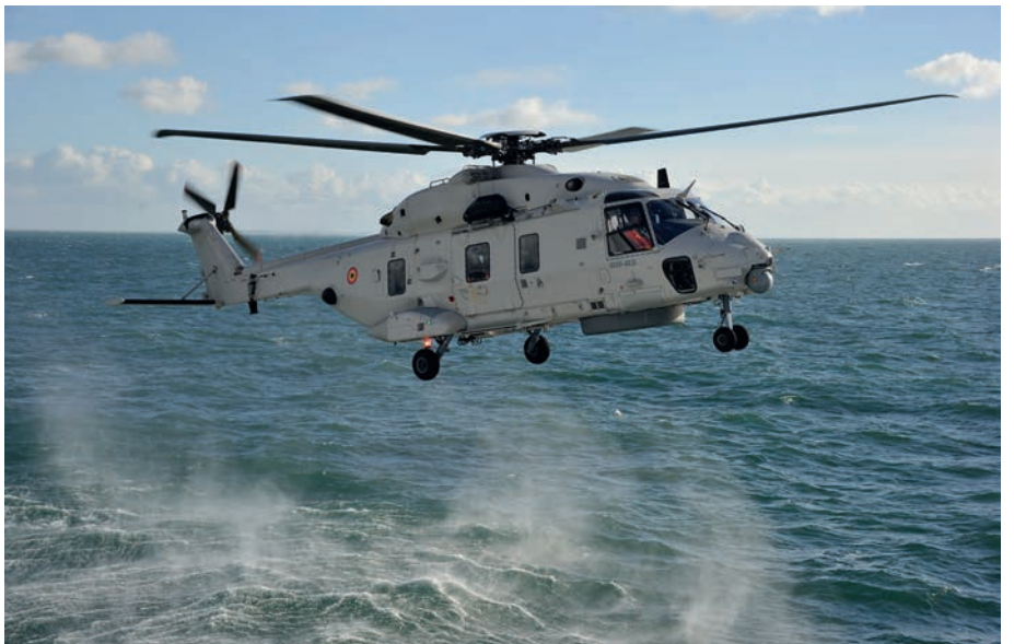
De Belgische NH90 komt eerst aan bakboord langs om vervolgens naar het dek op te schuiven. De rotorbladen zorgen voor grote wervelingen in het zeewater, geen wonder gezien de windkracht 8 die de z.g. downwash produceert.
