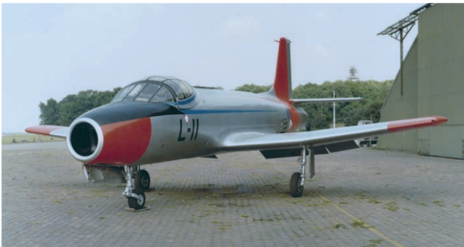
Het instrumentvliegen werd beoefend op de Fokker S.14 Mach Trainer. Voor dat doel kon de (rechter) stoel afgeschermd worden met een gordijntje om de leerling-vlieger geen zicht op de buitenwereld te geven. [Collectie Gerrit Boxem]
